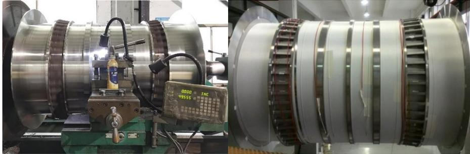
超导磁体骨架加工
