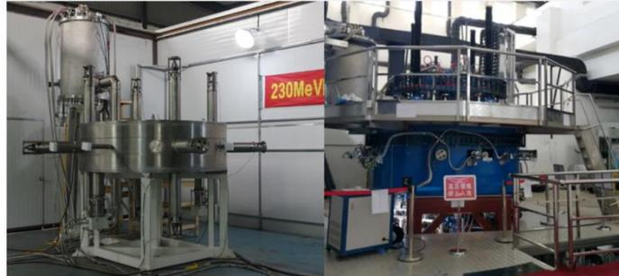
核心部件：回旋加速器超导磁体
