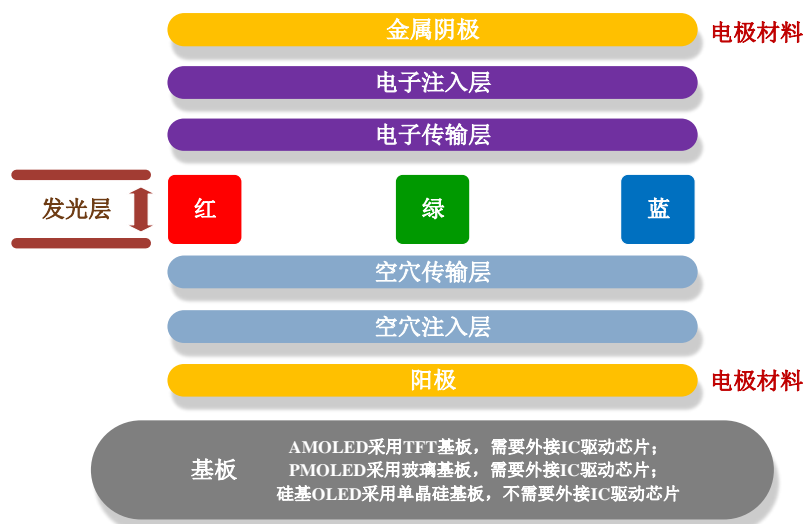
OLED 结构图
