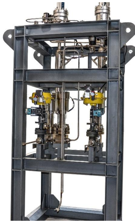
钠水反应试验装置
