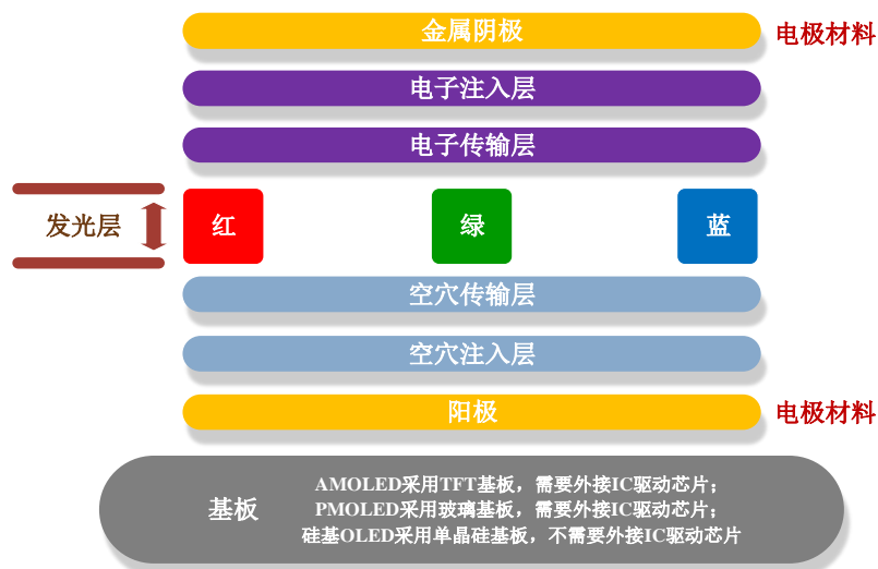
OLED 结构图
