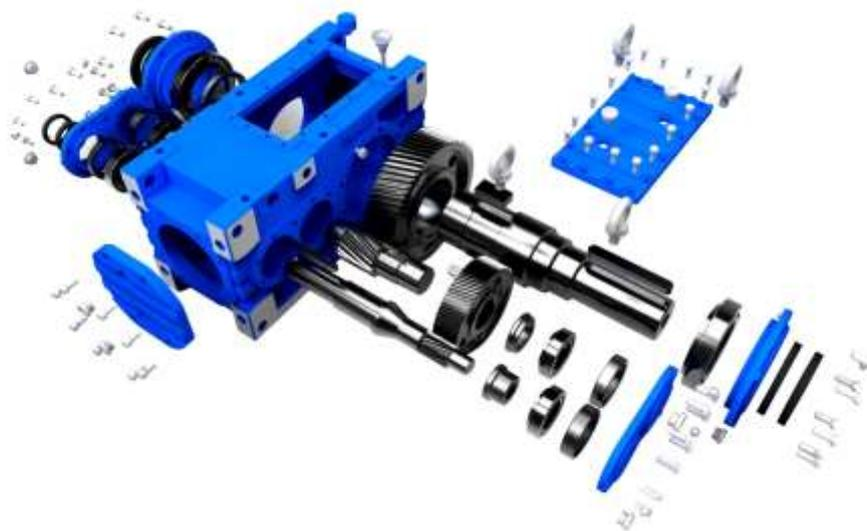
目前，公司借助组件模块化设计开发，以输入模块、输出模块和支撑模块三大体系为基本单元，开发研制出多个系列的通用减速机和工业齿轮箱产品。该类减速机产品的显著特点是实现了零部件集约化生产与组装，具有极强的通用性与互换性，零件的尺寸规格简化统一，大幅减少零件和毛坯的数量和种类。该技术的应用使得产品生产周期明显缩短，大幅度降低了库存水平，提高了综合效益。
