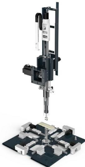
注：上图为多位置拉模折边结构图，包含实现该功能的核心零部件拉模机构、压盒机构等。
