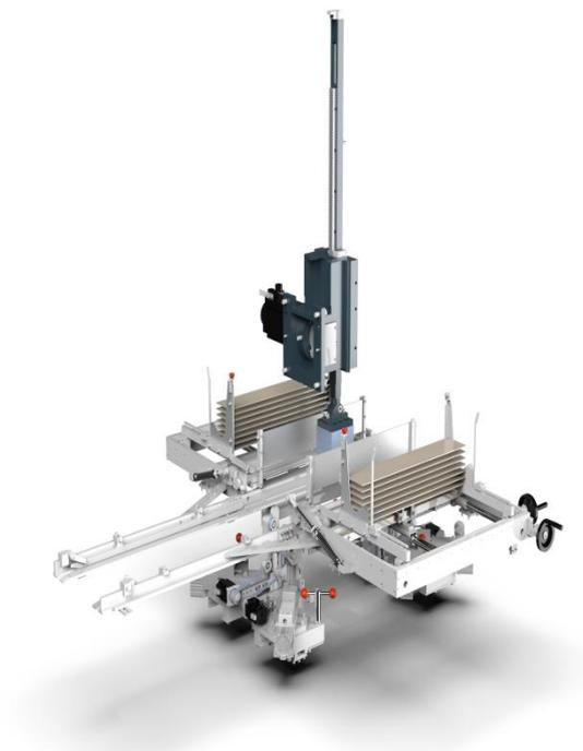
注：上图为多功能拼板贴角结构图，包含实现该功能的核心零部件吸纸机构、喷胶机构、拼板机构等。
