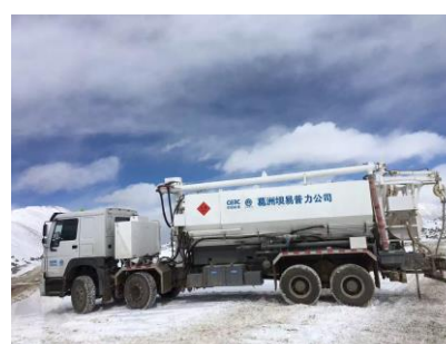
现场混装炸药
