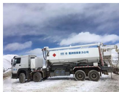
现场混装炸药
