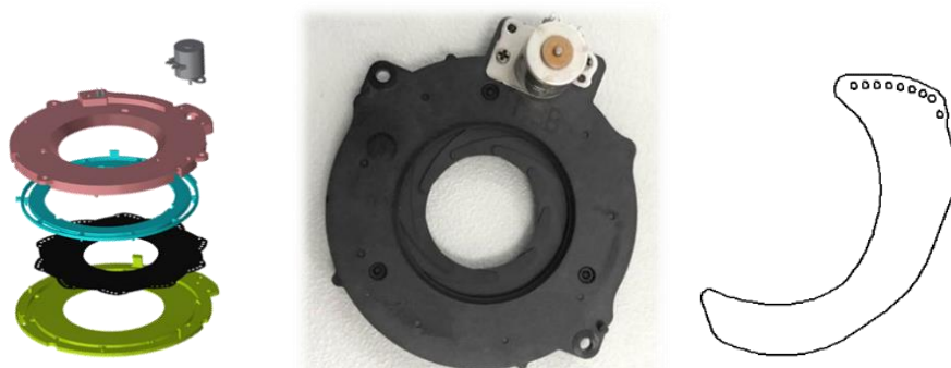
图：虹彩光圈结构与叶片结构 2D 图
