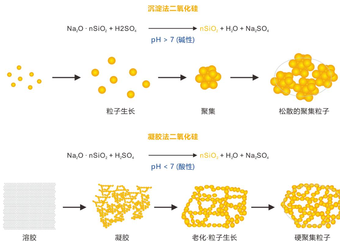
沉淀法工艺相对凝胶法工艺更易操作，生产过程可控性高，易实现工业化生产，但粒子容易发生团聚，不易制备粒径较小的纳米颗粒。凝胶法制备的产品形
