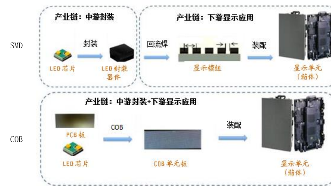
SMD 与 COB 两种生产流程对比
