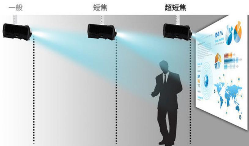
图：采用不同焦距镜头的投影设备示意
