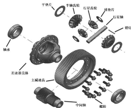
新能源汽车电驱传动部件总成结构图
