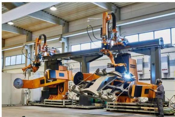
发行人工业机器人产品主要包括机器人第七轴、单龙门和双龙门系列桁架机器人、机器人集成工作站（焊接、切割）等，在船舶、工程机械、航空航天等领域均有所运用。
