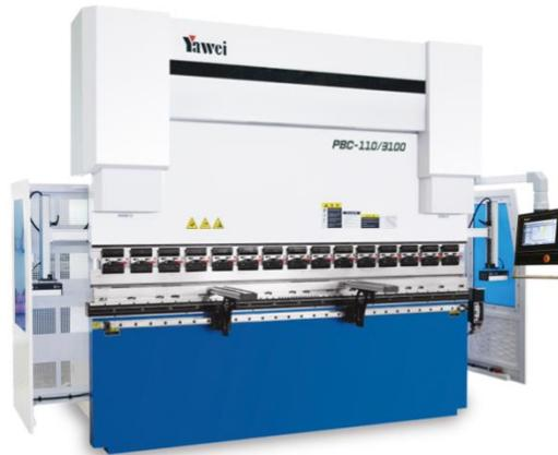
数控折弯机是为冷轧钣金加工设计的板材成形机床，利用所配备的模具将冷态下的金属板材折弯成相应几何截面形状的工件。数控折弯机作为工业母机之一，广泛应用于汽车、飞机制造、建筑幕墙、家用电器、电梯、轻工、造船、集装箱、工程机械、轨道交通等行业。
