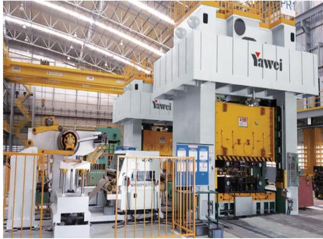
压力机是通过对金属坯件施加强大的压力使金属发生塑性变形和断裂来加工成零件的通用性机械设备。具有用途广泛，生产效率高等特点，广泛应用于切断、冲孔、落料、弯曲、铆合和成形等工艺。
