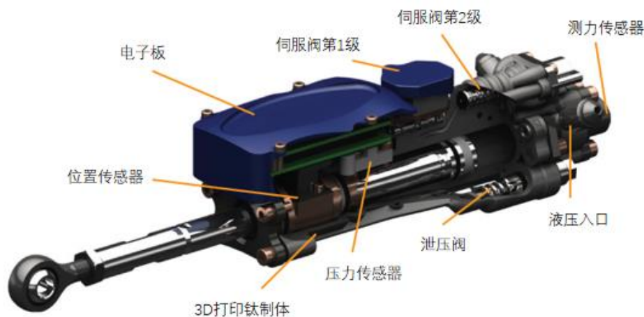
电液驱动关节结构示意图
