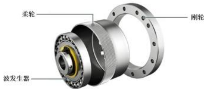
谐波减速器结构示意图
