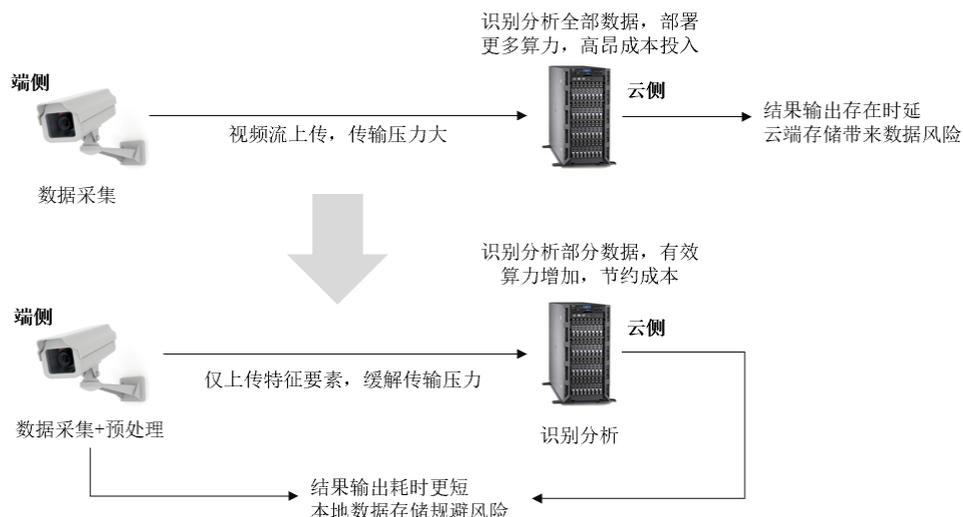
为了更好地平衡云侧和端侧的算力分布，实现整体效率的最大化，目前通过提升端侧和边缘侧的智能化水平和算力，实现整体算力分布的前置成为行业的新趋势。通过将部分算力和分析程序前置到终端设备，终端可以实现对数据的预处理，仅需将部分特征数据传至云端，甚至在本地完成对数据的完整分析。通过分布式算力部署，端侧设备形成的数据处理集群逐步向云侧设备融合。随着系统架构的不断优化，一方面这将增加有效算力，缓解带宽压力，减少设备的成本投入，另一方面数据的本地处理也能有效规避云侧分析带来的数据安全、隐私保护等风险。随着端侧芯片能够灵活支持更多算法，在云端集中的算力部署也将更加合理，最终实现“端云协同”的协同效应，即架构内算力、成本、时延、功耗的最优平衡。为实现这一效果，端侧对芯片的兼容性和灵活性有更高的要求，在控制成本和功耗的同时提升算力，从而实现云端部署和应用场景的灵活适配。
