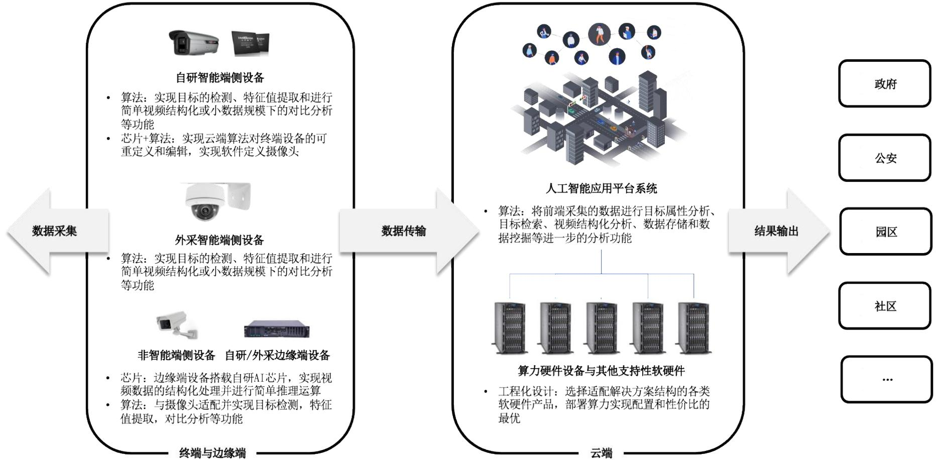
发行人的解决方案中，通过终端的智能摄像头等设备或边缘端的智能设备实现视频、图像数据的采集和简单结构化处理，通过光纤等介质将视频或图像数据传输至云端系统，进行数据的目标属性分析、目标检索、视频结构化分析、数据存储和挖掘等，最终输出结果至政府、公安、园区、社区、商业用户等最终用户。
