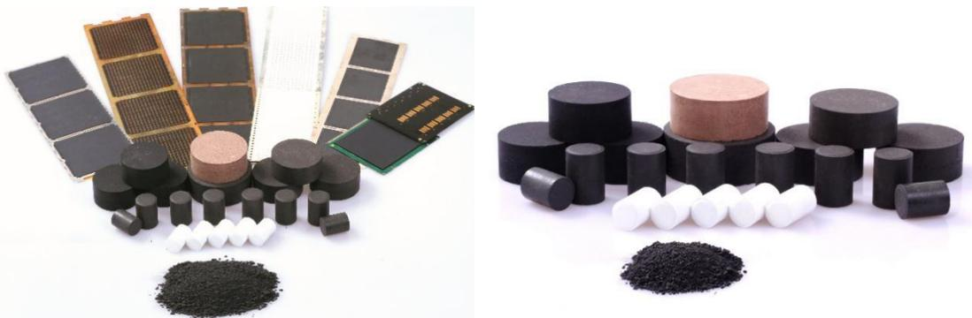
环氧塑封料（Epoxy Molding Compound，简称 EMC）全称为环氧树脂模塑料，是用于半导体封装的一种热固性化学材料，是由环氧树脂为基体树脂，以高性能酚醛树脂为固化剂，加入硅微粉等填料，以及添加多种助剂加工而成，主要功能为保护半导体芯片不受外界环境（水汽、温度、污染等）的影响，并实现导热、绝缘、耐湿、耐压、支撑等复合功能。
