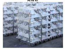
广泛用于电子工业、航空航天工业、交通领域、光学应用及化工冶金工业等领域,主要用于制作高压电容器铝箔、高性能导线、集成电路用键合线、高速轨道用合金、光学反光面等。
