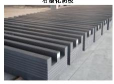
电解铝行业重要的、不可或缺的材料,用于电解槽下部。石墨化阴极具有 较高的导电率、导热性、抗钠浸蚀性和抗热震性,在大型电解槽电流强化生产 和节能方面有显著的优势。
