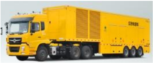
1600kW/10KV 中压电源车
