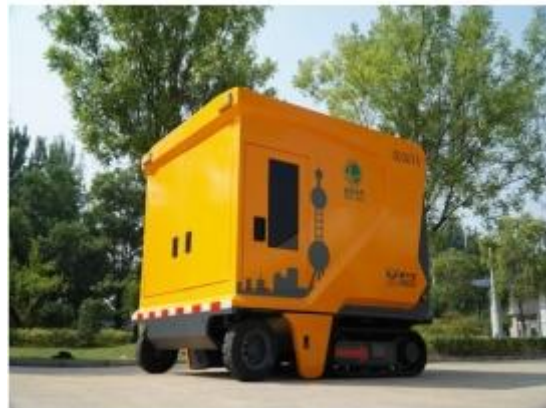
小型化履带式箱变车
