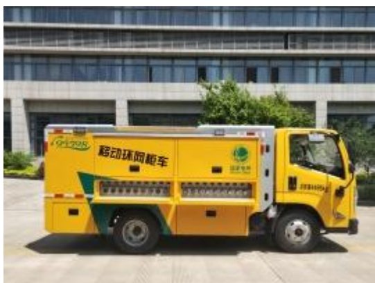
移动环网柜车（可进入地下室作业）
