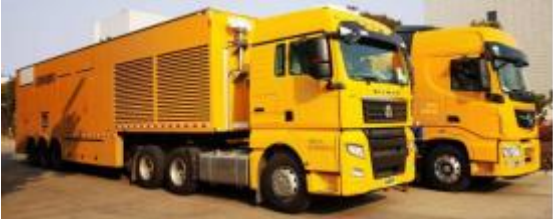
2000kW/10KV 中压电源车
