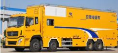
1000kW 中压应急电源车
