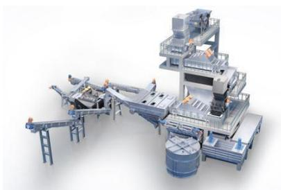
统、酸液循环系统三部分组成，主要作用是通过物理破碎和密度分选等工艺，提取废铅酸蓄电池破碎中的铅、铜、塑料等可再生物料，破碎能力和分选精度是衡量设备技术含量的重要指标。
