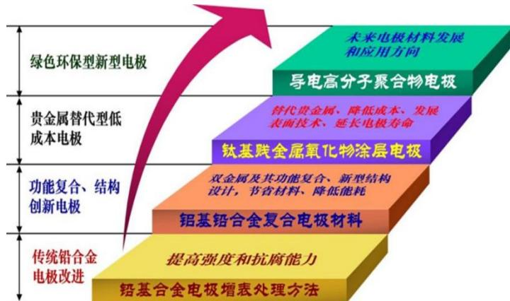
发行人目前已完成第二代阳极技术的产业化生产，其独创的第二代阳极——栅栏型铝基铅合金复合材料阳极为国内外首创，达到国际领先水平。发行人于2020年实现第三代阳极的小规模生产和销售，并已完成对第四代阳极的技术储备。
