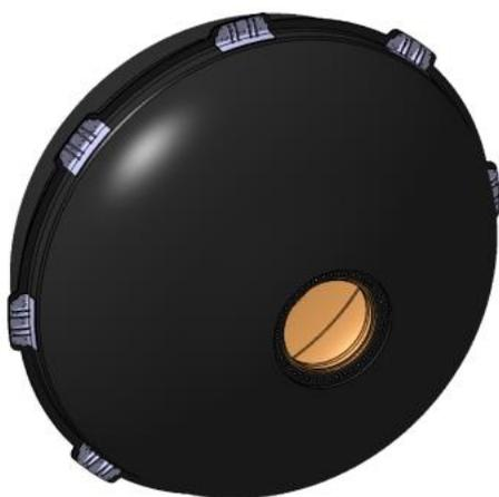
某火箭三级发动机复合材料壳体
