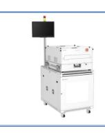
客户可以根据不同 PCBA产品测试需求 设计相应针载板, 通过更换不同的针 载板可以实现一条 产品线至另一条产 品线的快速切换。
