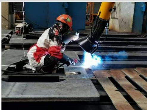
开展焊接烟尘技术攻关，改造后检测浓度值远低于国家标准限值，各作业点位平均烟尘量下降约 60%，成功实现了焊接烟尘的有效治理，极大改善了生产车间的作业环境。
