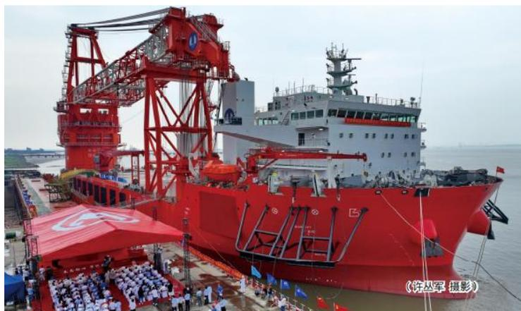
6月29日，振华重工参建的两艘国内“海上风电利器”——“乌东德”与“白鹤滩”号迎来交付和下水的关键节点。设计团队仅用70天时间，就完成了整套方案设计及细节落实。团队凭借多年来在起重机领域的专业经验和丰富积累，打造了全新多角度立体变幅缠绕绕绳系统；设计研发了国内最大的绕桩起重机，同时满足平台最大吊载吨位和最大绕桩尺寸，创造两项国内第一；通过多系统模拟，特别定制了高吊高、广幅度的浮式风电安装特定重型起重机。设计团队大胆创新、勇闯无人区的斗志和信念展现了振华重工打造国之重器的使命和担当。
