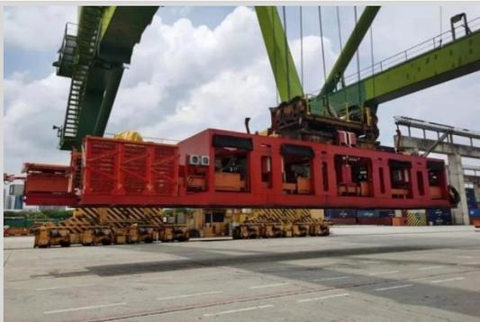
由公司自主研发的全球首台全自动拆装锁销平台正式交付用户。通过该项目共申请发明专利 9 项，实用新型专利 13 项，其中已授权发明专利 2 项，实用新型专利 12 项。该项目依托特大研发项目开展科技攻关，应用了工业六轴机器人技术、3D 视觉技术，自主开发了智能码垛方案、集装箱定位识别方案，能够覆盖多种作业模式，为世界首创。
