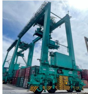
自主研发的一过一混动跨运车成功换代升级由原柴油机和锂电池的混合动力系统升级为氢燃料电池与锂电池的纯绿色动力系统，实现“零碳排放”
