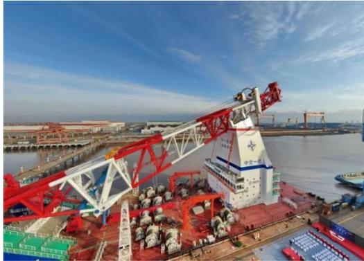
2022年1月7日，由一航局投资研发、上海振华重工建造的全球桩架最高、吊桩能力最大、施打桩长最长、抗风浪能力最强的专用打桩船——“一航津桩”正式交付。“一航津桩”实现多项首创革新，采用的液压动力系统实现了打桩船全电力“一键启动”便捷操作，首次采用全电力辅助推进可实现船体全方位灵活移船及方位调整，配备自主研发的施工管理控制系统，采用“北斗+近岸4G+卫星通信”组合技术，实现数字化管理、智能化施工、绿色化运行。
