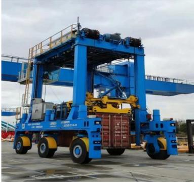
氢燃料电池跨运车，通过氢气和空气中的氧气进行化学能反应，产生电能进行驱动，整个循环只产生水和热，不产生任何有害物质。氢燃料电池运行噪声只有 55 分贝左右，大大降低整个港口的环境噪音
