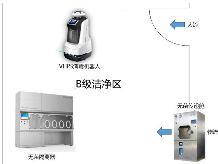
公司自主研发的环境生物污染控制装备主要包括：隔离器、无菌传递舱、过氧化氢消毒机及配套设备构成。隔离器由不锈钢、钢化玻璃构成的刚性舱体，或由透明聚氯乙烯制成的柔性舱体及空气净化单元、控制系统等组成，主要应用于医药行业中无菌药品的研发、生产和检验；高活性药物生产、临床调配的阻隔；生物安全防护。无菌传递舱由不锈钢制成的硬墙舱体及空气净化单元、集成式过氧化氢发生单元等组成，用于物料从低级别洁净区转移至高级别洁净区时，对物料表面进行生物去污处理。过氧化氢消毒机是将特定浓度的过氧化氢溶液汽化或雾化，并通过喷嘴或管道扩散至密闭空间内进行消毒的设备，主要用于对洁净厂房、生物安全柜、生物安全实验室、医疗场所、急救车等密闭空间及无菌制药设备进行消毒。
