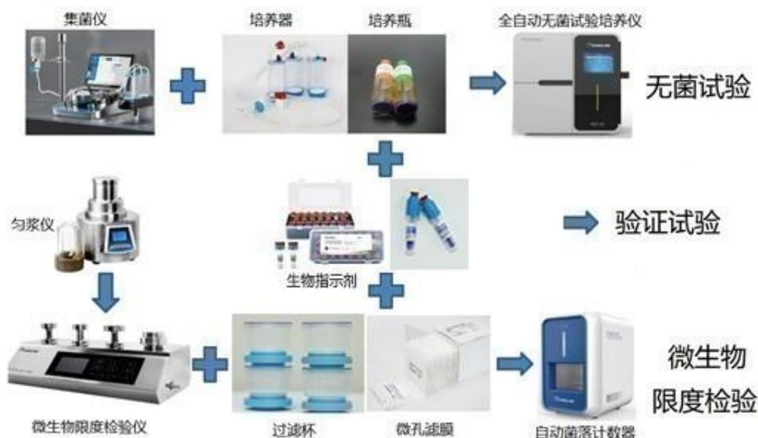
公司自主开发的微生物检测系统主要包括：由集菌仪、培养器（培养瓶）及全自动无菌试验培养仪组成的无菌检测系统，用于注射剂等无菌药品的无菌检查；由匀浆仪、微生物限度检测仪、过滤杯、微孔滤膜及自动菌落计数器组成的微生物限度检测系统，用于各类药品微生物限度检查、水质菌落总数检测及医疗保健产品的生物负载测定。基于工作原理是：借助集菌仪或微生物限度检测仪进行增压或抽真空，检品通过特定的膜过滤器进行过滤，将检品中的微生物进行富集，然后通过无菌操作向培养器内注入特定的培养基，或将滤膜无菌转移至培养基上进行培养。上述仪器的操作均需在洁净的环境中操作，可以集成于隔离器内，在受控的环境中完成检验工作。最终检验结果可以通过无菌试验培养仪或菌落计数器分析，并判定检品是否无菌或微生物含量是否超标。
