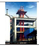
ZYL 中央链斗式提升机的牵引件为单链,被广泛用来提升各种散状物料,对进料稳定性有一定要求,最大运行速度1.9m/s,最大提升量1450m³/h,最大提升高度70m,可提升温度不超过250℃的物料。
