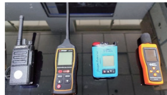
为员工配备对讲机、燃气检测仪、氧气检测仪、噪声监测仪
