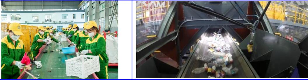
虽然，人工分拣在目前行业中相对常规，但从长远发展来看，其存在以下主要问题：①随着劳动力成本的不断提升，劳动者对工作环境的要求越来越高，“用工短缺”等问题将越加凸显；②人工分拣的准确率、分拣效率受工人自身经验、能力的影响较大。如，因可回收物构成较为复杂，即使完成上岗培训，新上岗分拣员的分拣准确率、效率都较熟练员工低一些；③完全依靠人工分拣，许多物料无法进行深层次细分，一些较高价值的物料存在价值流失的问题。
