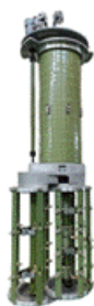
SHZVII 型换流真空有载分接开关，最大通过电流 1300A，最大级电压 6000V，额定切换级容量 6000kVA
