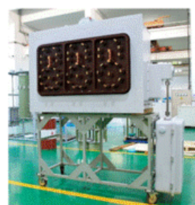
HWDK 电抗式真空有载分接开关，适用于设备最高电压 69KV 以下（含 69KV），三相电流分别为 1500A、2000A，额定频率为 50HZ 或 60HZ，三相接法为 D 接或 Y 接变压器。
