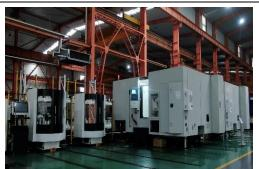
生产线由两台以上卧式加工中心、自动化立体库和 MAS 管理软件组成,软件包括加工系统、物料储运系统、控制与管理系统。可以提高设备利用率,稳定产品质量。同时对生产排程、订单管理调度、加工物料仓储、刀具管理等都有较大提高,实现精益自动化生产。
