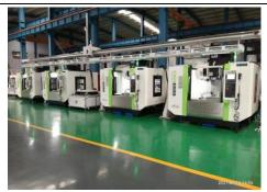
由桁架机器人将多台 855 立式加工中心组成自动化生产线,替代传统的辊道线,降低人工成本,实现全自动化刀具加工,提高工作效率。此生产线已经成熟运用于刀具自动化加工行业,大大提高的了刀具加工完成率。
