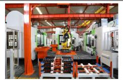
将三台立加品字形布局,配合中间的关节机器人,组成缸体柔性 化生产单元,配置智能视觉识别 系统、自动检测系统,实现不同 规格发动机缸体的柔性化加工, 提升生产效率。
