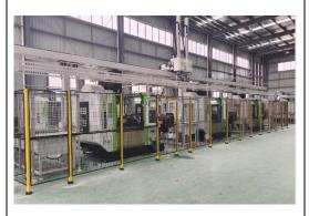
由双 Z 轴桁架机器人和三台立式 加工中心,搬运夹具,工件翻身 夹具,上下料链板线和安全围栏 等组成的自动化生产线。此桁架 机器人运行速度快,定位精度高, 适用同时加工两个工件的工况, 能大大减少机床等料时间,提高 工作效率,降低工人劳动强度。 此生产线已经成熟运用于新能源 汽配加工行业,大大提高了零配 件加工效率。
