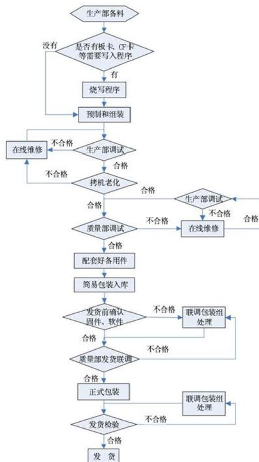
工业机器人的生产由相应子公司负责，生产流程图如下：
