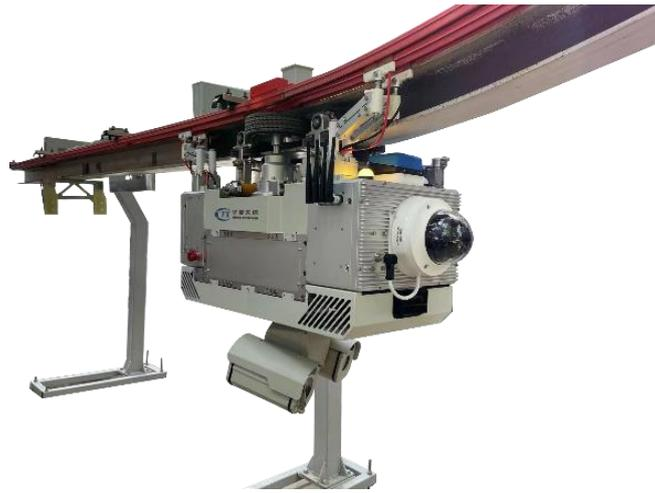
图 35、极寒轨道式智能巡检机器人
