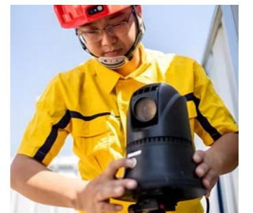
• “球机 + 智能安全帽”实现工程施工后台实时监管
