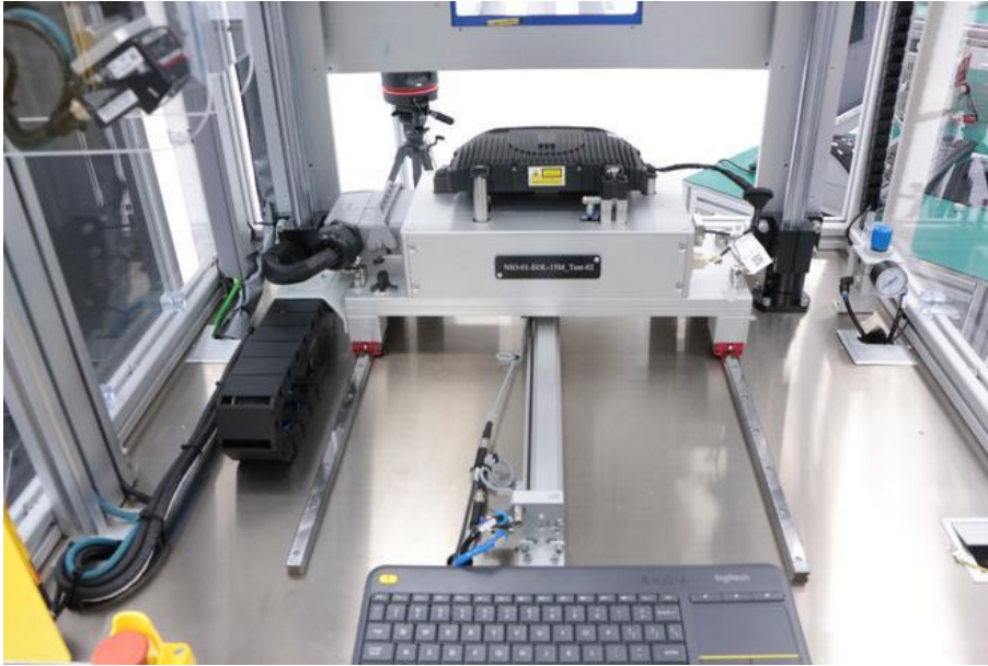
图:均普智能激光雷达产线 EOL 终检测试台
