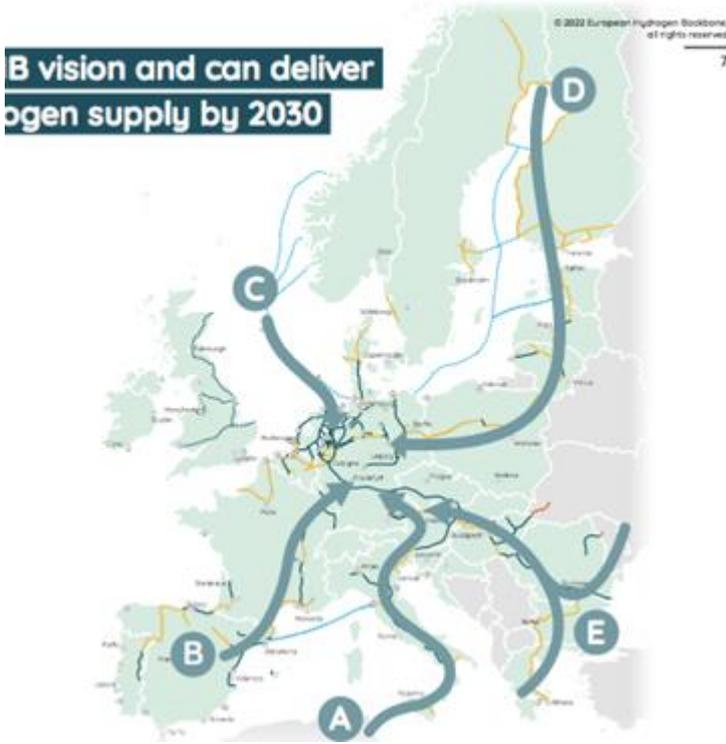
图：计划到 2030 年建成 5 个泛欧氢气供应和进口走廊（北海走廊、北欧和波罗的海走廊、东欧走廊、西南走廊、北非-意大利走廊）
