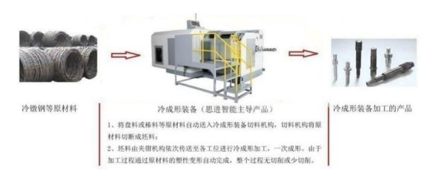
公司持续加大新产品研发力度。截至当前,公司可以生产八工位以内的冷成形装备。冷成形装备的"工位"数指加工产品过程中的变形次数,"工位"数一般与冷成形装备的定模数一致。公司冷成形装备在加工产品过程中,采用回转工作台或回转夹具等,使工件先后在机床上占有不同的位置进行连续加工,每一个位置上进行一次动模冲击定模的加工变形,称作一个工位。如五工位冷成形装备就是将工件经过五次加工变形后,生产出符合要求的产品,某型号零件在其内部变形加工过程如下图所示:
