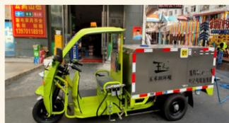
三轮电动车载高温高压清洗车
