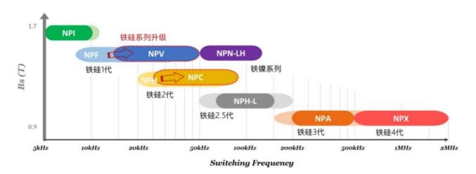
公司始终以终端应用需求为产品开发导向,以精密制造工艺为支撑,从"铁硅 1 代"金属磁粉芯开始,不断迭代升级至"铁硅 4 代",建立了一套覆盖 5kHz~2MHz 频率段应用的金属磁粉芯体系,可满足众多应用领域的性能需求,牢牢抓住终端用户。2022 年,公司重点推出了全新铁硅系列磁粉芯(NPV 系列)、非晶及纳米晶粉末。作为面向碳化硅时代的新型磁性材料,NPV 系列保留了出色的直流偏置能力,并且磁芯损耗实现了大幅优化,为电源模块节省铜线、提升效率做出巨大贡献,客户满意度得到极大提升。
