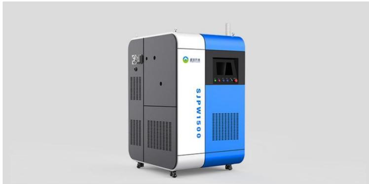
L/S 是 Local Scrubber 的简称，是泛半导体工艺设备 PFCS 污染物处理装置，用于对制程过程中产生的含氟、氯、硅等元素为代表的成分复杂的有毒有害废气进行源头处理，该设备一端与泛半导体工厂工艺设备相连，通过真空泵抽取工艺设备内产生的废气并进行分解；另一端与中央治理系统相连，将分解后的尾排气体排至中央处理装置并进行后续处理。L/S 属于泛半导体工艺制程设备的一部分，其运行稳定性及气体处理效率要求高。
