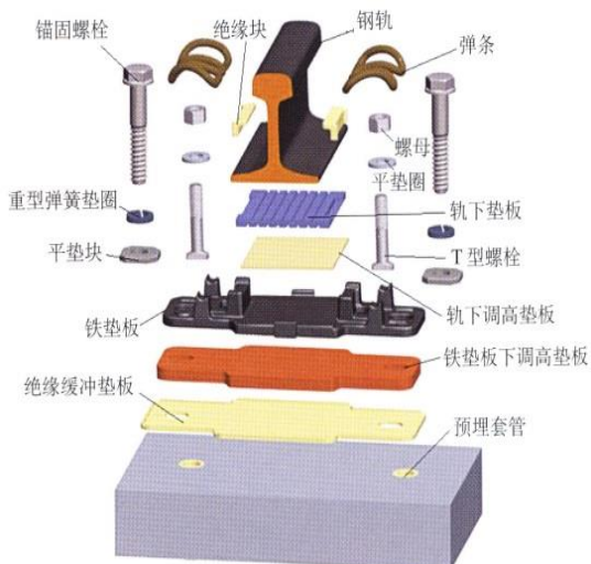
WJ-7型扣件组装零件图
