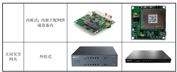
公司智能安全网关产品根据在系统中的部署位置可分为终端安全网关与主站安全网关。其中,终端安全网关部署于广泛分布的配电自动化终端,主站安全网关部署于配电主站侧。
