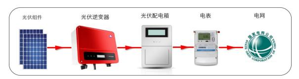
公司的光伏并网逆变器均为组串式逆变器。相较于集中式逆变器,组串式逆变器具有最大功率跟踪电压范围宽、转化效率高、组件配置灵活、性能安全可靠等特点,可满足户内、户外等不同的应用环境要求,目前已广泛应用于住宅、商业屋顶、农场、地面电站等光伏发电系统。经过多年的研发投入和积累,公司光伏并网逆变器产品种类齐全,组串式光伏并网逆变器已涵盖0.7kW~320kW 功率范围,可以全面满足各种类型光伏组件和电网并网要求,稳定高效运行于高温、高海拔、风沙、盐雾、低温等各种自然环境。
