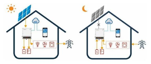
光伏储能逆变器的技术路线根据是否与电网连通主要分为并网型光伏储能和离网型光伏储能,其中以并网型光伏储能为主。离网型光伏储能系统主要应用于海岛、无电网覆盖的偏远地区等场景。随着部分国家对光伏并网发电补贴越来越低、部分区域甚至取消补贴,以及并网售电价格的下降,储能将成为提升并网光伏系统收益的重要手段。同时,光伏发电作为一种间歇性能源,发
