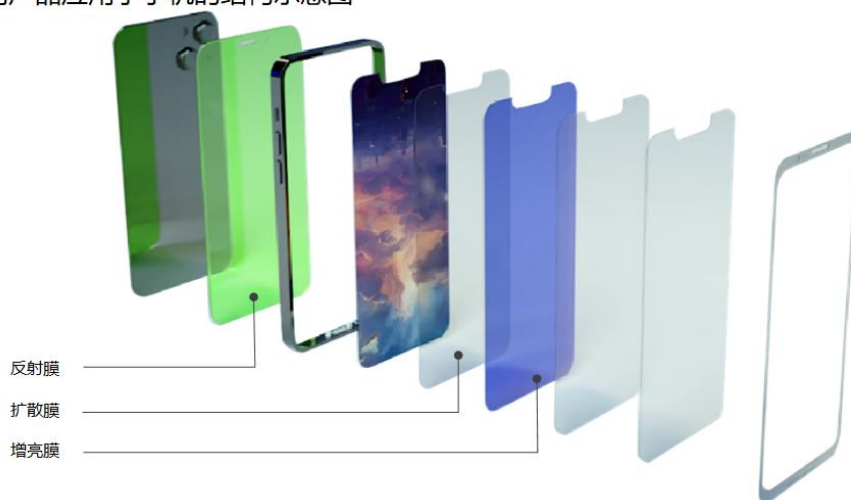
公司产品应用于手机的结构示意图
