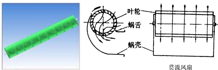
贯流风叶的外观如上图所示。这种风叶采用前向式叶片，叶轮的轴向宽度很宽，呈滚筒状，两端密封，气流沿叶轮径向流入，穿过叶轮内部，然后沿径向从另一端流出。其由新型工程塑料成型，采用超声波焊接成形，通过高温时效处理和动平衡修正，保证产品长久耐用，适用于常用环境条件下的送风系统，特点是噪音低、音质柔和、低压强风，因此特别适宜于分体机的室内机组。如下图：
