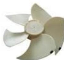
轴流风叶常用 AS 树脂等工程塑料等注塑成型，叶轮上有螺旋桨状的叶片。轴流风叶向前直接送风，通过模具一次注塑成形，具有质量轻、能效比高、风量大、抗老化的特点，主要应用于家用空调室外机及其他各类散热通风设备。如下图：
