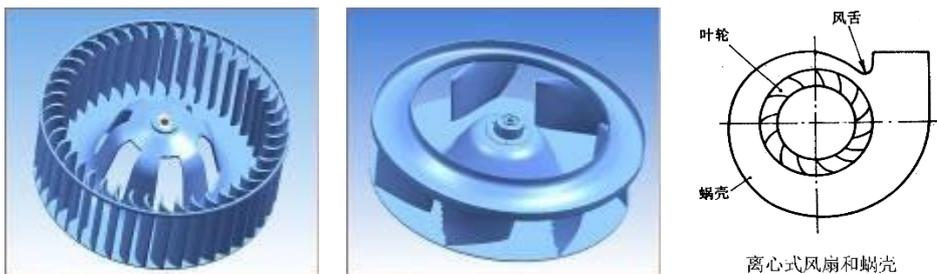
离心风叶与蜗壳、轴和轴承等组成离心风机，离心风叶一般用 AS 或 ABS 制成；蜗壳由两块蜗形侧板、风舌和吸风口风圈等组成，蜗壳的横断面为矩形，其截面积逐渐增大，使空气流速逐渐减慢，从而将空气的动压力转换为静动力；吸风口风圈带弧形，其作用是降低噪声，提高效率。离心风叶的空气流动是从轴向进风，径向出风。离心风叶结构紧凑，尺寸小，风量大，噪声比较低，而且随着转速的下降，其运行噪声显著降低。一般应用于家用空调室内柜机或吸顶机，如下图所示：
