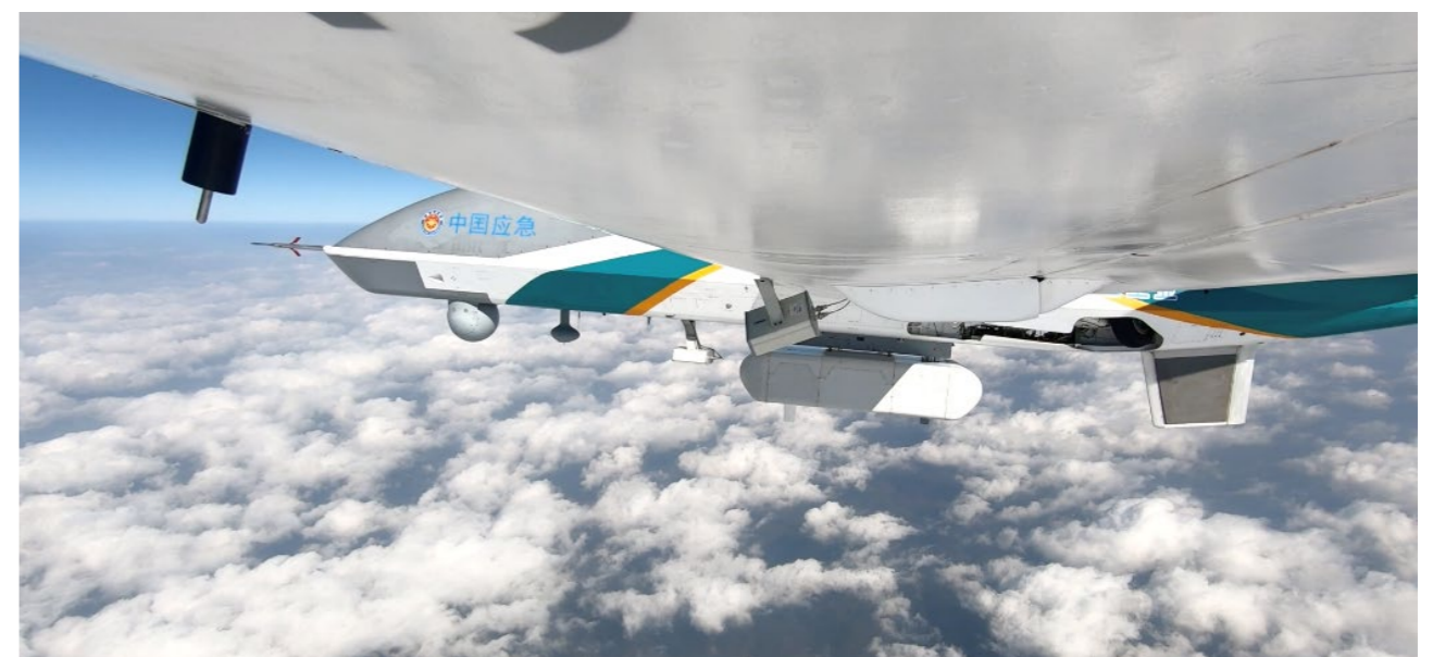
搭载大型无人机应急多任务模块化即插即用敏捷开放集成平台的无人机
