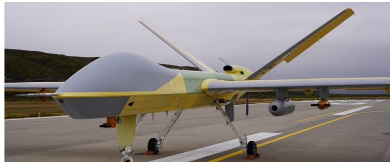
搭载无人机先进电热复合涂层防除冰系统的无人机
