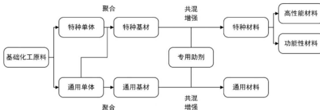
高分子新材料由基材通过添加专用助剂进行改性之后加工成型。高分子新材料基材是由具有大量不饱和键的单体聚合形成重复结构单元的高分子量化合物，如具有不饱和键的乙烯（ $\text{CH}_2=\text{CH}_2$ ）形成- $\text{CH}_2-\text{CH}_2$ -结构单元，聚合而成聚乙烯（PE）基材。用于生产通用高分子新材料基材的单体称为通用单体，相应地，特种高分子新材料基材由特种单体或特种单体加通用单体共聚生成，往往某种类特种单体在特种高分子新材料基材中用量占比相对较低，但由于其是高分子新材料性能改善、功能增强的关键，因此具有用量少、价值高的特点。
