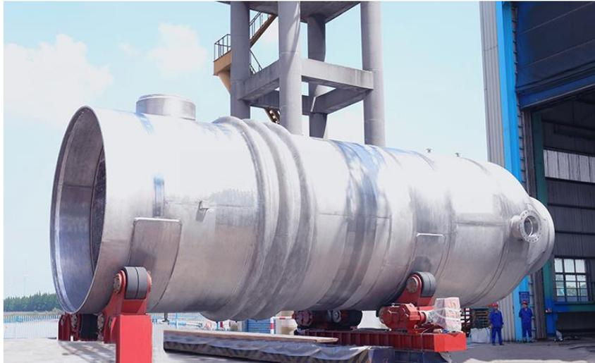
深孔焊（内孔焊）换热器
