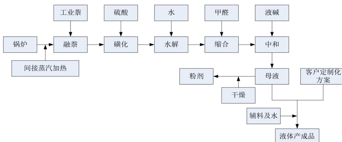
萘系外加剂的合成过程主要由磺化、水解、缩合及中和等四道工序组成：工业萘经蒸汽加热熔化后，在压力作用下经密封的管道输送至磺化工序；在磺化工序内加入硫酸进行磺化后生成  $\beta$ -萘磺酸，在压力作用下经密封管道输送至缩合工序，与加入的水进行水解反应后，与甲醛缩合成  $\beta$ -萘磺酸甲醛缩合物；然后在压力作用下经密闭管道输送至中和工序，用液碱中和得  $\beta$ -萘磺酸甲醛缩合物钠盐，加水稀释后成为萘系外加剂母液（液体成品）；或者通过干燥成为粉剂，以供较远距离的复配厂使用。
