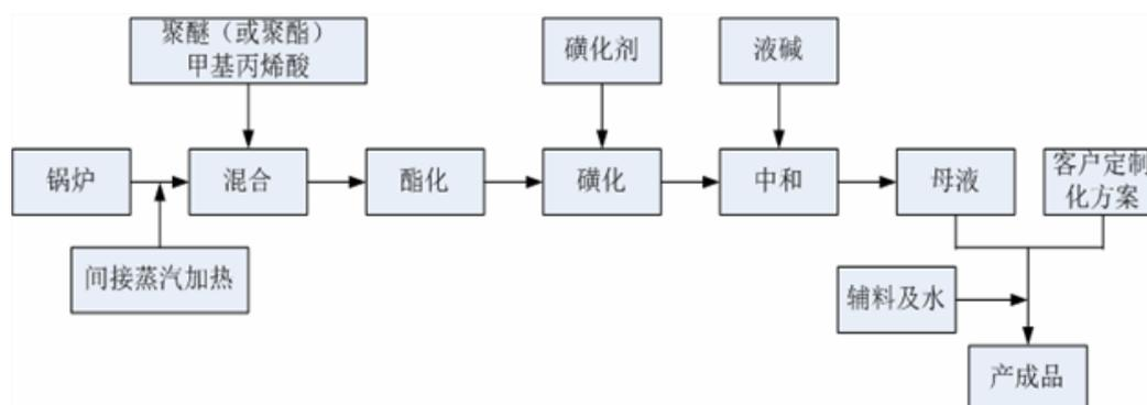
聚羧酸系外加剂的合成过程主要由酯化、磺化及中和等三道工序组成：在反应釜中加入聚醚、聚酯单体、甲基丙烯酸等，通入少量惰性气体，间接升温后并保持一定时间进行酯化。然后加入磺化剂，在一定温度下，保温一定时间进行磺化。然后加入液碱进行中和调节 PH 值至适当范围内即可得到成品。其中，酯化并非生产聚羧酸外加剂必经步骤，只有为体现聚羧酸外加剂某些特性时才需要进行酯化，否则可不经酯化，混合后直接进入磺化工序。
