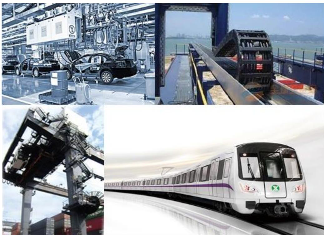
由于港口机械、大型自动化生产线和机器人、机车等设备，通常面临高强度机械应力、扭曲和弯曲应力以及户外作业的恶劣环境，故柔性电缆通常具备高柔性、耐油、耐磨损、耐紫外线、抗氧化、抗微生物、抗水解、抗撕裂等特殊性能。
