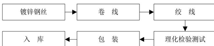
如以上工艺流程图所示，福星新材料已建、在建项目主要产品的工艺流程
